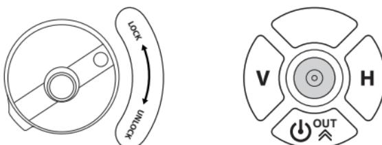
Клавиша H управляет включением/отключением горизонтальной линии. Клавиша V отвечает за включение/выключение вертикальной линии, повторное нажатие включает вторую (у LP-62), третью и четвертую (у LP-64) вертикали. Лазерный отвес включается при нажатии кнопки V. Для работы с наклонными плоскостями при выключенном приборе нажмите кнопку OUT и проверните тумблер.
