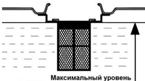
Рис. 8 Максимальный уровень топлива в топливном баке
