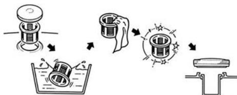
Рис. 15 Обслуживание сетчатого фильтра в горловине топливного бака
