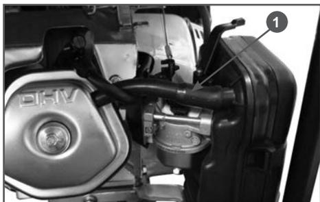
Рис. 12 Трубка системы вентиляции картера
