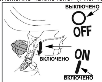
Рис. 13 Выключатель зажигания в положении «Включено»
