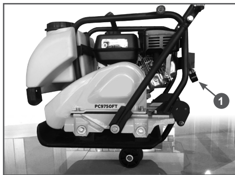
Рис. 26 Использование транспортировочной тележки 1. Зажим
