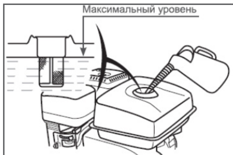
Рис. 7 Максимальный уровень топлива в топливном баке
