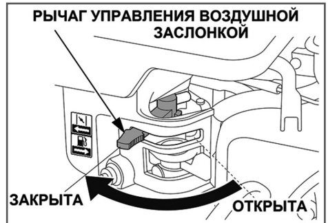
Рис. 11 Воздушная заслонка закрыта
