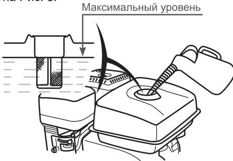
Рис. 8 Максимальный уровень топлива в топливном баке
