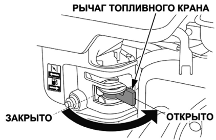
Рис. 9 Топливный кран открыт
