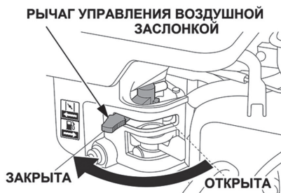
Рис. 10 Воздушная заслонка закрыта
