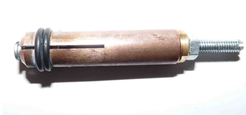
4-schlitzige Kupferbolzenaufnahme für M4 Schweißbolzen (Ø 4 mm)
