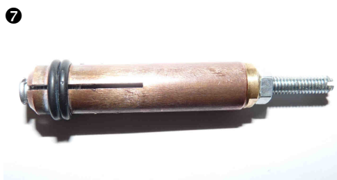
4-schlitzige Kupferbolzenaufnahme für M4 Schweißbolzen (Ø 4 mm)
