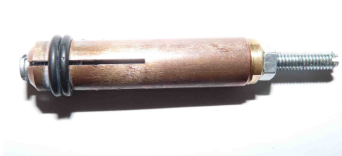
Embout en cuivre à 4 fentes pour souder les goujons M4 (diamètre Ø 4 mm)
