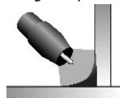
Die Frequenz ermöglicht die Konzentration des Lichtbogens : Je höher die Frequenz, desto schmäler ist der Bogen. Je niedriger die Frequenz, desto breiter ist der Bogen. Im AC Modus müssen Sie die Frequenz manuell einstellen. Im AC Easy Modus wird diese Funktion automatisch per Mikroprozessor, je nach Elektrodendurchmesser und eingestelltem Strom angepasst. Benutzen Sie möglichst den AC Easy Modus.
