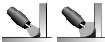
La frecuencia permite ajustar la concentración del arco.
