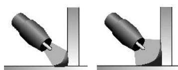
La fréquence permet d'ajuster la concentration de l'arc. Plus on veut un arc concentré, plus la fréquence doit être élevée. Plus on diminue la fréquence, plus l'arc est large. En position AC, la fréquence se règle manuellement. En position AC Easy, ce paramètre se règle automatiquement en fonction du diamètre de l'électrode utilisée et du courant de soudage. Utiliser de préférence la position AC Easy.
