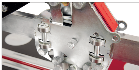
Механизм каретки состоит из 13 шарикоподшипников.
