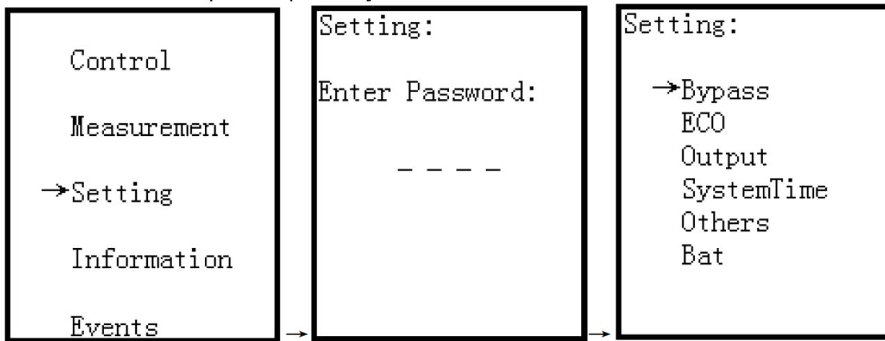
Меню содержит следующие подменю: байпас (Bypass), Эко (ECO), Выход (Output), Системное Время (SystemTime), Другие (Others), АКБ (Bat). Каждое подменю позволяет настроить соответствующие параметры. Некоторые из параметров возможно изменить только в определенных режимах работы ИБП. В случае, если изменение параметра невозможно в данном режиме, будет выведено сообщение «Item can't be set in this mode».
