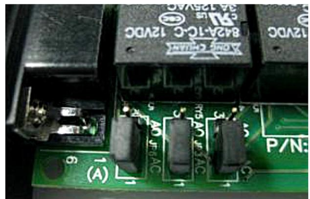
Для установки “сухого контакта” в состояние “нормально-разомкнутый” должны быть замкнуты контакты 2 и 3 соответствующего джампера JP (см. рис. 6.4)
