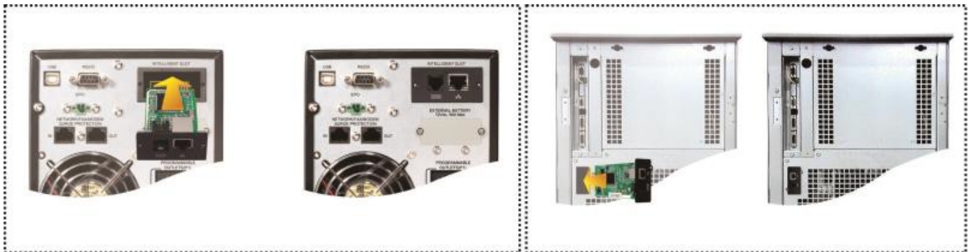
Рис.2-1 Установка SNMP-адаптера в слот опционального оборудования.
