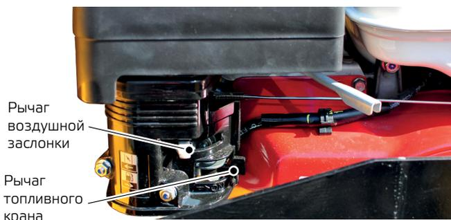
1. Полностью закройте воздушную заслонку, передвинув ее рычаг на карбюраторе до упора влево.
