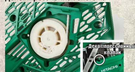
Благодаря защите стартера можно работать в сильно запыленной среде, а декомпрессионный клапан уменьшает усилия при запуске двигателя.
