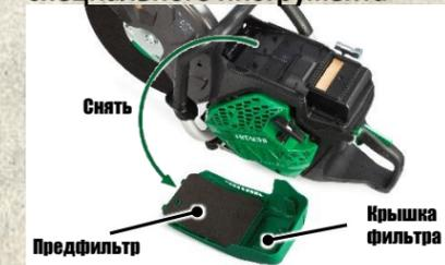
Для чистки предфильтра нужно лишь просто снять крышку, не используя специальные инструменты.
