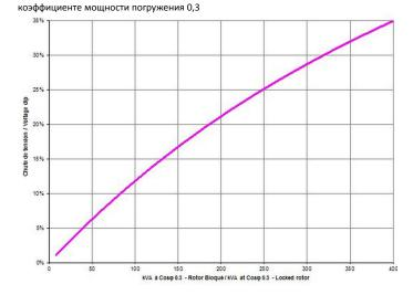
Пиковый запуска двигателя (кВА), основанный на х% напряжения при
