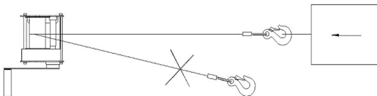
7.2. В случае если канат находится под другим углом, используйте блок для подводки каната.
