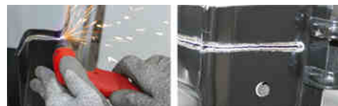
СТАЛЬ : макс 6 мм ALU : макс 4 мм (Скорость = 20 см/мин при 20A)
