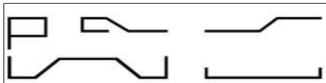
Рис. 5 Формы изгиба арматуры
