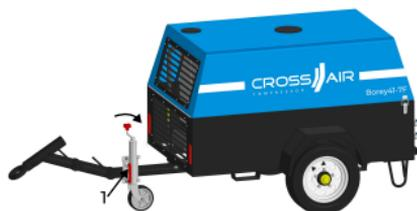
После первых 100 км пути, пожалуйста, проверьте и снова затяните колесные гайки и затяните болты, чтобы они соответствовали указанному моменту затяжки.
