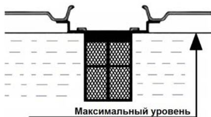
Рис. 10 Максимальный уровень топлива в топливном баке
