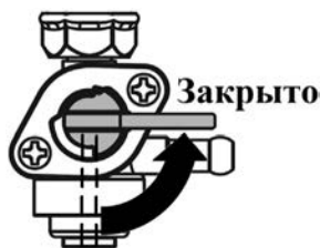
Рис. 7 Топливный кран закрыт
