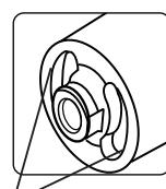
Необходимо заклеить отверстия на задней части сверла. При использовании этого способа пыль удаляется не так хорошо, как при использовании отдельного пылеудалителя, из-за небольшого отверстия в адаптере. Периодически проверяйте не забито ли отверстие в адаптере пылью, при необходимости очищайте.
