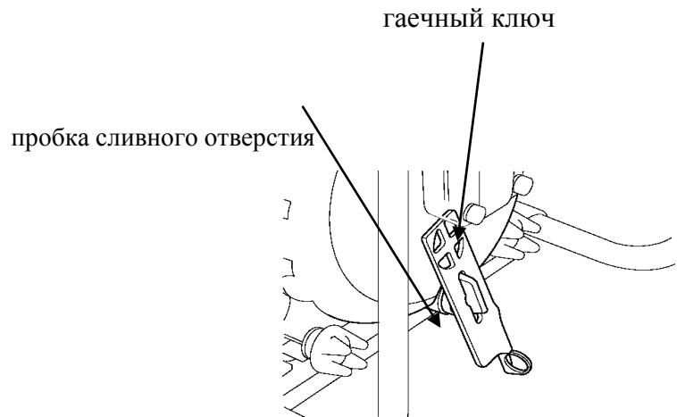
2. При помощи гаечного ключа ослабьте гайки крепления крышки насоса.
