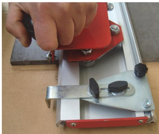
Для использования присоски поверхность керамической плитки должна быть гладкая (рис.4). Рез плитки необходимо осуществлять от начальной точки плитки до конечной с одинаковой скоростью. При разломе плитки необходимо мягко нажать на щипцы для разлома (рис.5). Разлом нужно производить в начале и конце плитки.
