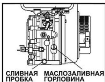
Тип масла: при использовании генератора в теплых условиях (от +10°C) мы рекомендуем SAE 10W30. При использовании генератора при низких температурах (ниже 0°C), рекомендованное масло SAE 10W40.
