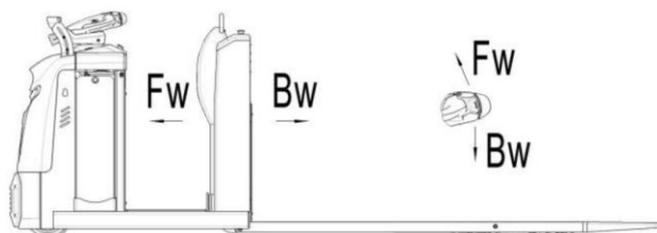
При переводе маховиков в нейтральное положение, включается система торможения, которая действует до полной остановки подборщика заказов. Когда подборщик полностью останавливается, включается парковочный тормоз.
