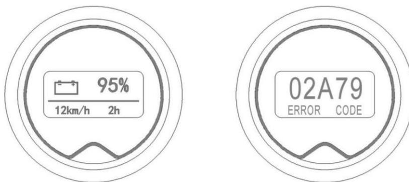
Слева на рисунке показан основной интерфейс индикатора, который отображает емкость аккумулятора, суммарное время работы (моточасы) и скорость движения.
