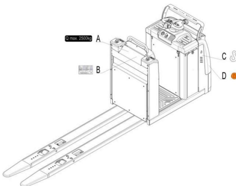
Подборщик заказов оснащен кнопкой противоотката, которая изменяет траекторию движения подборщика заказов и направляет его в другую сторону от оператора, если подборщик движется на оператора, и ручка управления находится в рабочей зоне.
