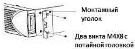
Рис.3 Установка монтажных уголков
