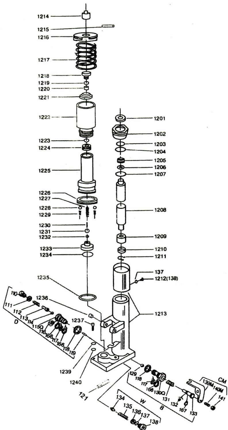
**Перечень деталей насосного узла (Быстрый подъем).**
