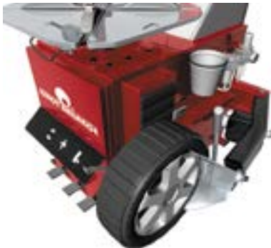
Рисунок 4 – Отжим шины от диска
