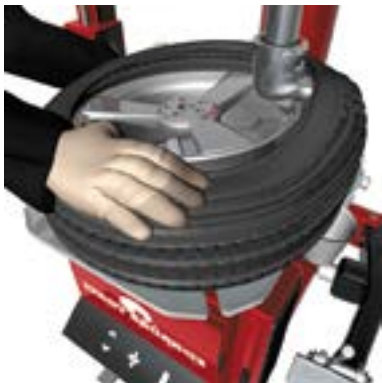
Рисунок 6 – Установка шины на обод
