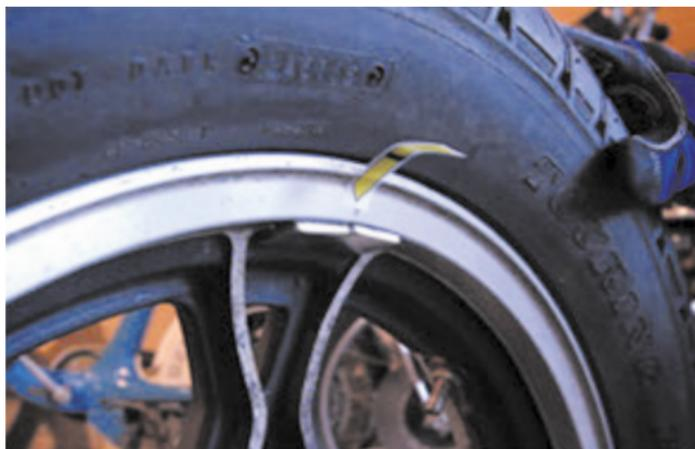
Рисунок 10 – Определения тяжёлой точки колеса
