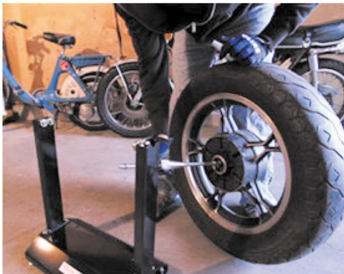
Рисунок 7 – Снятие вала
