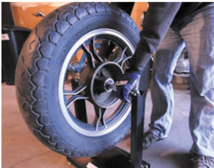
Рисунок 8 – Установка вала с колесом
