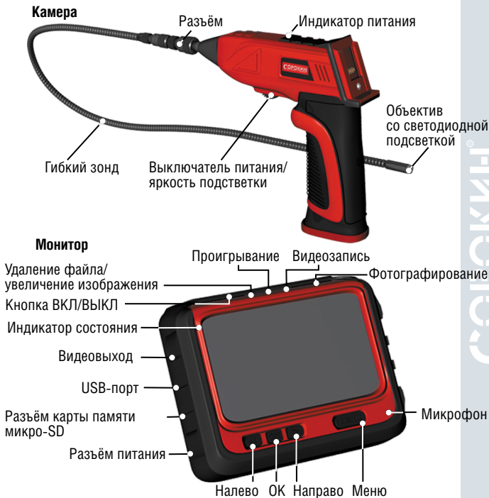
Рисунок 2 – Устройство изделия
