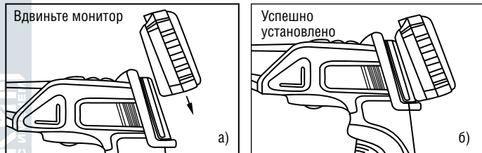
Рисунок 6 – Установка монитора на блок управления
