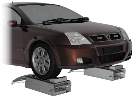
**Рисунок 5 – Установка автомобиля на эстакады**
