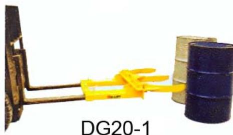
Аккуратно вставить захват между ребрами жесткости бочек. Фиксация бочек произойдет автоматически.
