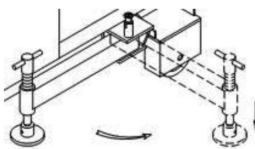
Во время использования подъемника платформа может подвергаться внешним воздействиям (движение человека на платформе и прочее). Чтобы обеспечить устойчивость оборудования, необходимо увеличить площадь его опоры с помощью консольных опор, расположенных по углам рамы.
