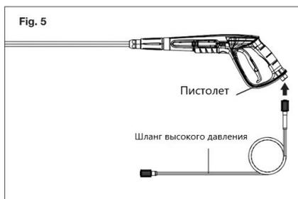
7. Подсоедините другой конец шланга высокого давления к выходному отверстию мойки высокого давления.
