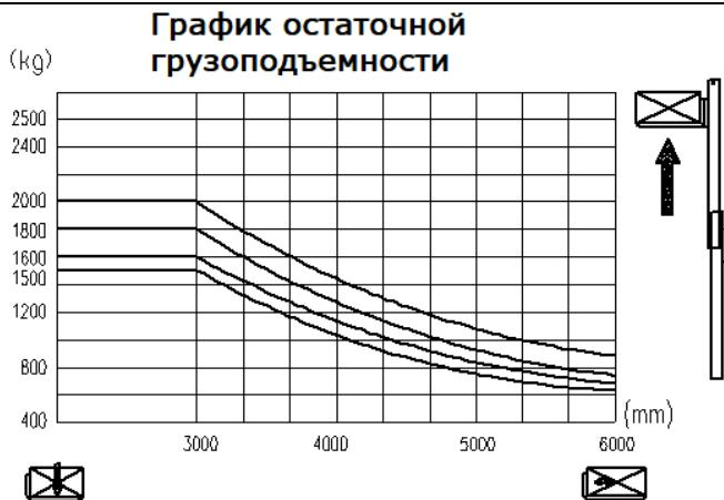
\*При наличии функции бокового смещения вил, грузоподъемность уменьшается на 150кг.
