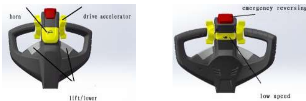
Рис.4 Horn – звуковой сигнал; lift/lower – кнопки управления «вверх»/«вниз»; drive acceleration – высокая скорость; emergency reversing – кнопка аварийного обратного движения; low speed – медленная скорость.
