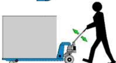
Груз поднимается при движении ручки гидравлической тележки.
