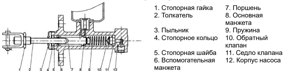
Рис. 2-10 Тормозной гидроцилиндр
