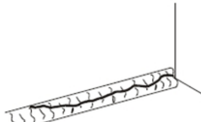
Трещина на сварном шве
