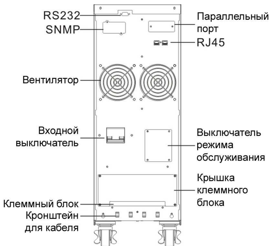
Рисунок 1.5 – ИБП модификации NT3110L. Вид сзади
