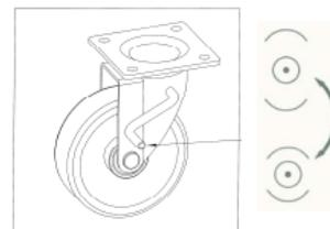
Рис. 5: Тормозной механизм
