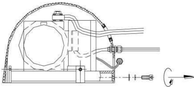
2. а) Установите вертикальную стойку и крышку, затянув фиксатор, как показано на рисунке
