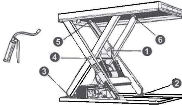
**При смазке подшипников подъемный стол не должен быть нагружен !**
