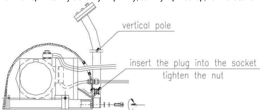
б) Вставьте вилку, соединяющуюся с электрической коробкой, в розетку на вертикальной стойке, затем затяните винт.
