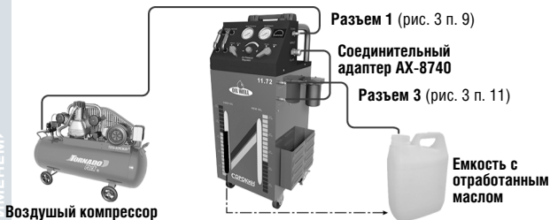
Рисунок 6 – Схема процесса слива отработанного масла из стенда
