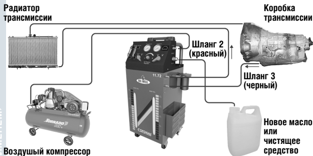
Рисунок 4 - Схема процесса цикла очистки
