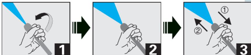
Рисунок 2 – Регулировка струи
