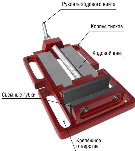
Рисунок 1 – Общее устройство изделия
