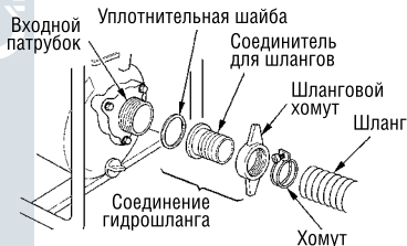
Рисунок 7. Подключение шлангов.
