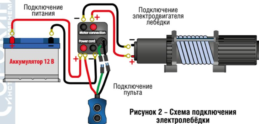
Рисунок 2 – Схема подключения электролебедки
